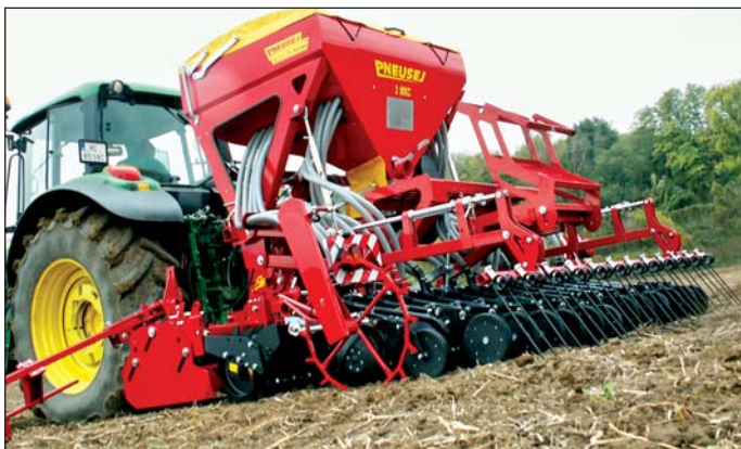
Novinka z portfólia PD Hlohovec nesie označenie MKC. Umiestnením zásobníka nad rotačné brány bližšie k traktoru sa znížila potreba zdvižnej sily.
