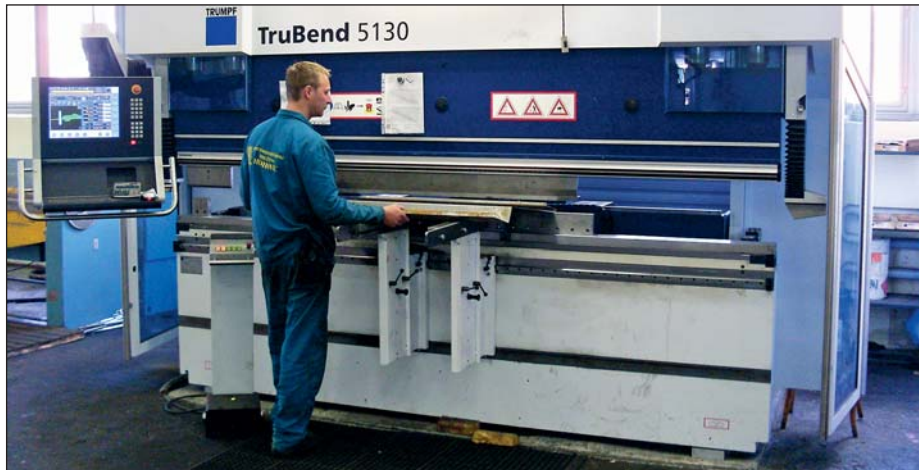
V PD Hlohovec disponujú najmodernejšími strojmi v oblasti obrábania strojov. CNC ohraňovací lis značky Trumpf má silu 130 ton na dĺžku 3 230 mm.
